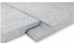
Placa compuesta por una mezcla de yeso y celulosa, y prensada hasta conseguir 1.100 kg/m<sup>3</sup> que la hacen **ideal para soleras secas**. Clasificación al fuego A1 - No combustible.
