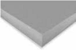
Compuesta por un alma de yeso enriquecida con fibra de vidrio. Placa utilizada en el sistema Shaftwall que protege del fuego hasta 3 horas y ofrece una alta resistencia mecánica gracias a la placa Maciza 20 además que facilita su instalación por un solo lado gracias al desarrollo de un Montante especial CT.
