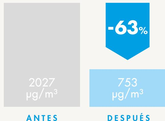
Prueba en sala de fumadores cubierta en un 80 % de placas CLEANEO perforadas (0,27 m<sup>2</sup> CLEANEO / m<sup>3</sup> local), recubiertas con una capa de imprimación y una capa de pintura. Resultados a los 3 meses de su instalación. Los valores medios son para COV en períodos prolongados, lo que permite eliminar los picos debidos a la presencia de fumadores.
